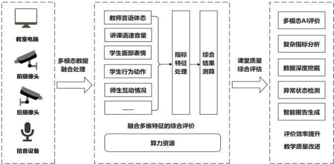
图 2 AI 课堂质量评测系统架构图
